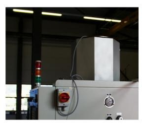
Bei der Entwicklung des Emulsions- und Oelnebel- Absauggeräts EONAG wurde Wert auf vielfältige Einsatzmöglichkeiten gelegt. Deshalb kann das EONAG für unterschiedliche Absaugmedien eingesetzt werden, wie Emulsionsnebel aus Fräs - und Drehzentren, Oelnebel aus Flachschleifmaschinen oder auch für Wasserdampf. Der EONAG ist auch als Absauggerät bei Entgrat- oder Handarbeitsplätzen geeignet.
